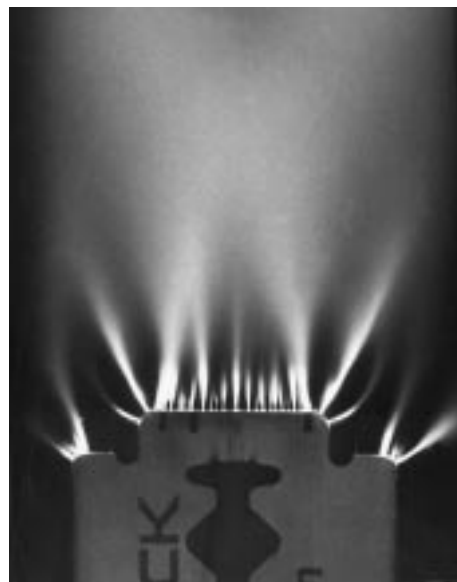
Рис. 3. Фотография коронного разряда с бритвенного лезвия при подаче на него положительного электрического потенциала \sim 10 кВ, полученная в темноте с выдержкой 10 с
